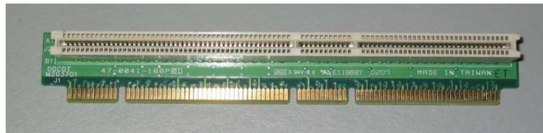
Connecteur PCI 64 bits (5 V)
