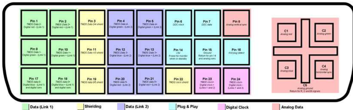
description des pins du connecteur DVI
