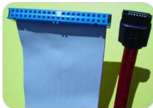
Comparaison entre le câble PATA (à gauche) et SATA (à droite)
