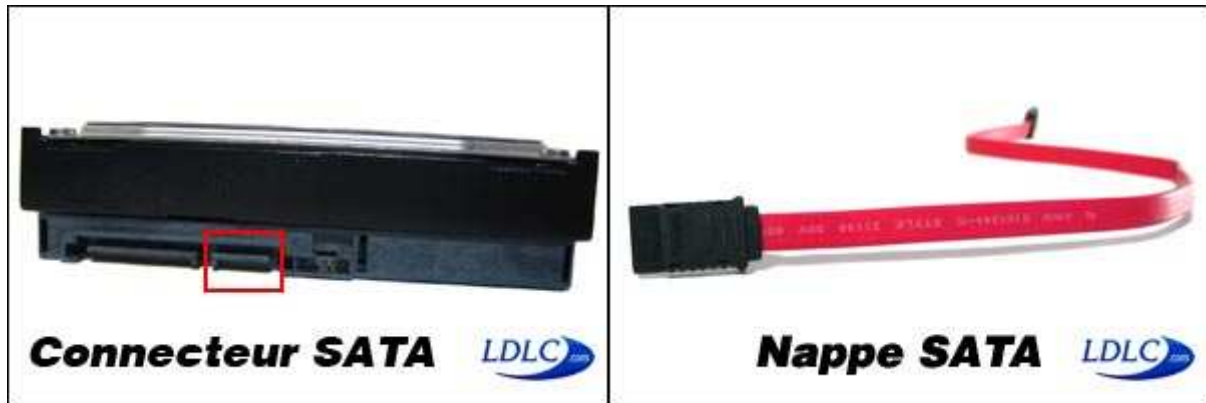
Aperçu d'un connecteur S-ATA et d'une nappe S-ATA
