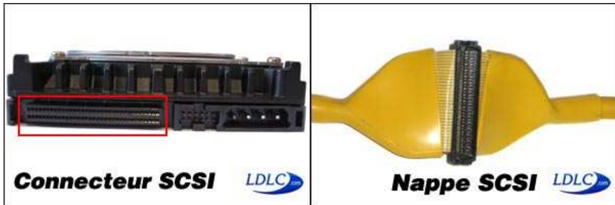
Aperçu d'un connecteur SCSI et d'une nappe SCSI
