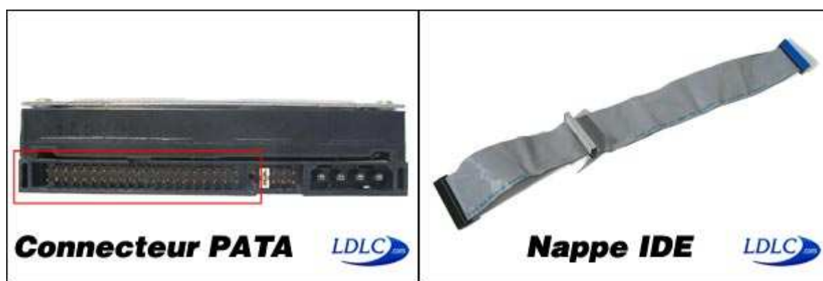
Aperçu d'un connecteur P-ATA et d'une nappe IDE
