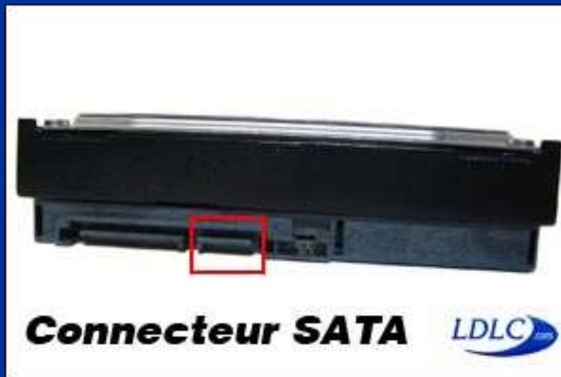
Aperçu d'un connecteur S-ATA
