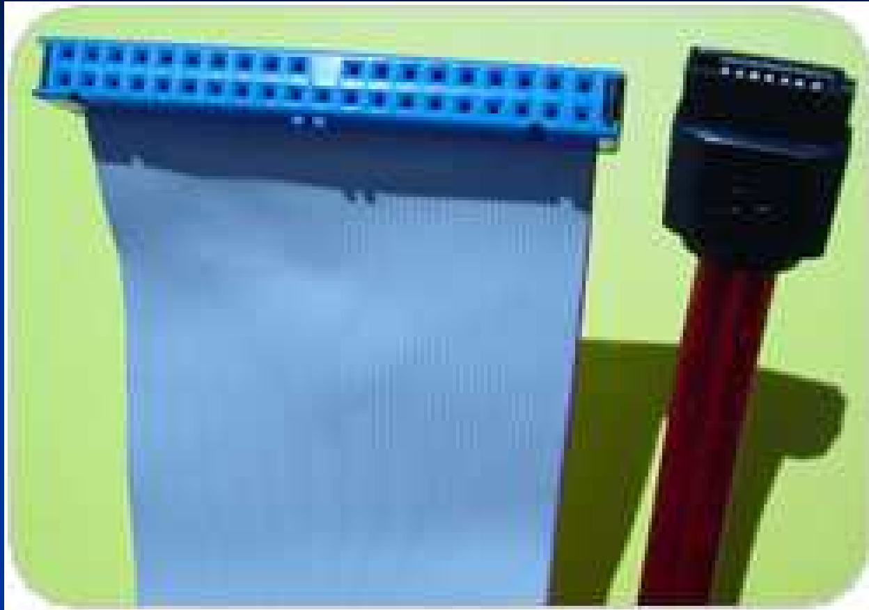
Comparaison entre un câble P-ATA et un câble S-ATA
