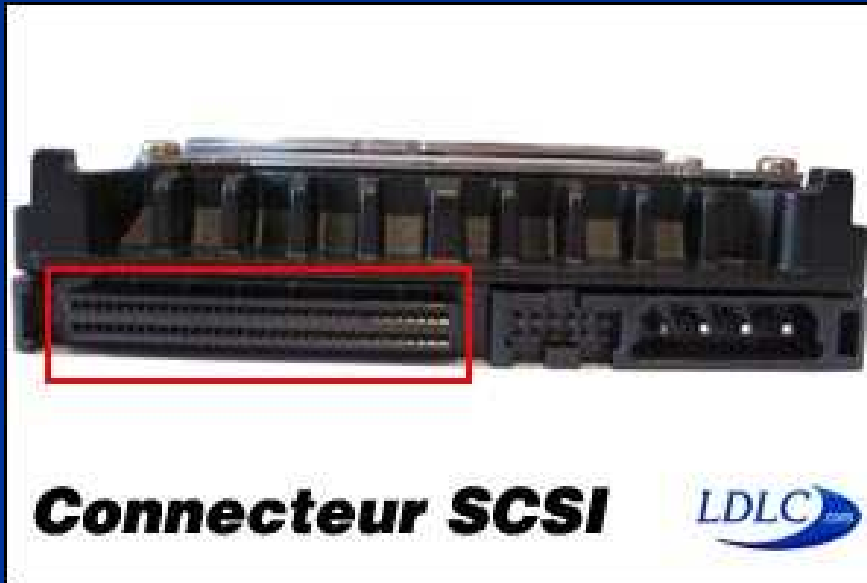
Aperçu d'un connecteur SCSI
